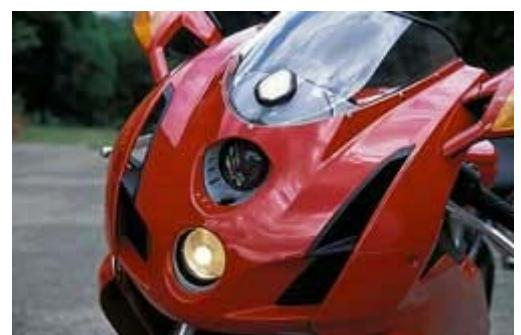
Как следствие, шум на скоростях вплоть до 250 км/ч стал существенно меньше. Это достигнуто за счет слегка расширенного и заниженного обтекателя и измененной формы зеркал заднего вида, оснащенных регулировочными ручками
