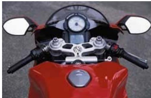
Конфигурация бака на 999 коренным образом отличается от 916: теперь топливо частично расположено в нише под седлом, что позволило сузить его боковины и отштамповать более существенные углубления для коленей. Благодаря сочетанию малой высоты по седлу и подштамповок на баке водитель попадает за руль как патрон в патронник. Безусловно, посадка на Ducati 998 была не в пример удобнее, чем на 916-й, но с 999-й ее просто
