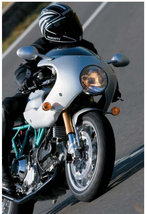
К последним относятся: совершенно современная рама в духе традиционной пространственной «птичьей клетки» со стальной фермой, на которую повешен силовой агрегат (здесь стоит отметить, что у прародителей этих ремейков этот узел представляет собой разомкнутую структуру), высокотехнологичные японские (О, ужас! Такого раньше никто и не мог подумать) подвески Ohlins со
